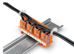
Zugentlastung durch Kabelbinder am Adapter, quer zur Klemmenanschlussrichtung; Klemmstellenkennzeichnung durch Beschriftungsstreifen (210-334)
