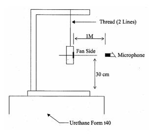
1 METER FROM MICROPHONE TO FAN INTAKE
