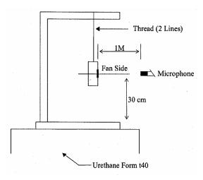
1 METER FROM MICROPHONE TO FAN INTAKE
