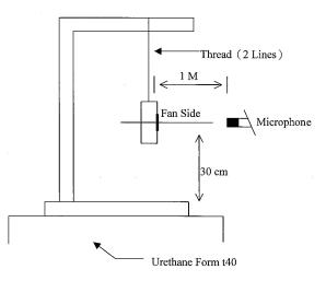
1 METER FROM MICROPHONE TO FAN INTAKE
