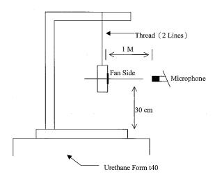
1 METER FROM MICROPHONE TO FAN INTAKE
