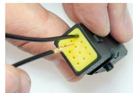
2. Führen Sie die gecrimpten Kontakte durch die Einzeladerdichtung in die Kontaktkammern ein.
