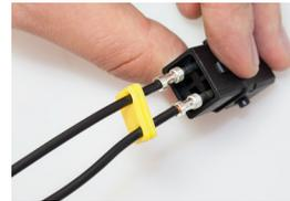
2. Crimpen Sie die Kontakte und setzen Sie sie in die Kontaktkammern ein.
