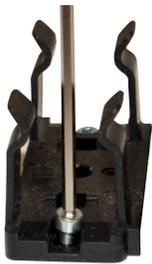
1. Schrauben Sie den Montagerahmen auf die Installationsfläche. Das Anzugsdrehmoment beträgt 0,3 Nm.
