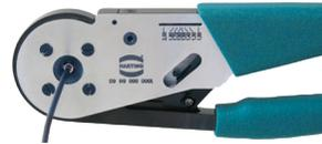
1. Crimpen Sie die Kontakte entsprechend den Spezifikationen.
