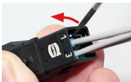
1. Hebeln Sie den Kontaktträger aus dem Gehäuse.
