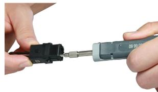
2. Entfernen Sie Han D® Kontakte mit dem Demontagewerkzeug 09 99 000 0012.
