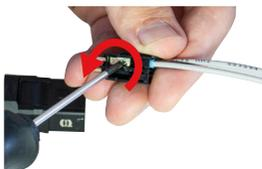
2. Lösen Sie die Schrauben auf dem Kontaktträger.
