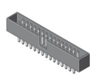
Wannenstecker im Rastermaß 2,00 mm in vertikaler oder horizontaler Ausführung ohne Verriegelung. Low profile-Ausführung mit einer Bauhöhe von nur 5,60 mm.
