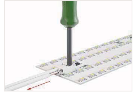
Feindrätige Leiter anschließen und Leiter lösen – durch geringen Druck auf den Drücker, z. B. mit Betätigungs- werkzeug 206-860.
