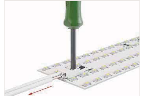
Feindrähtige Leiter anschließen und Leiter lösen – durch geringen Druck auf den Drücker, z. B. mit Betätigungswerkzeug 206-860.
