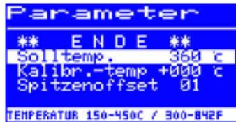
Durch Drücken und Halten des i-OP für ca. 2 Sekunden wird der Parametermodus für das Lötwerkzeug aktiviert.
