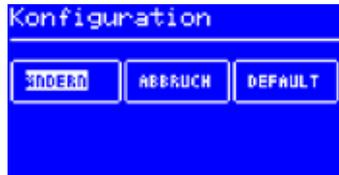
In den Konfigurationsmodus gelangen Sie, indem Sie beim Einschalten der i-CON 1 den i-OP für 5 Sekunden gedrückt halten.
