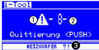
Die i-CON 1 führt selbständig Fehlerdiagnosen durch. Das Ergebnis einer Diagnose wird als Fehlercode ausgegeben: Dabei erscheint das dreieckige Piktogramm ① im Display der Lötstation. Der Fehlercode ② wird als Zahl zwischen 2 und 99 angezeigt. In der unteren Zeile wird zusätzlich ein Hinweistext ③ angezeigt.
