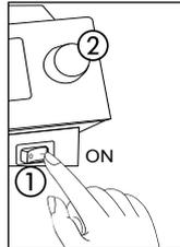
Das Ein/Ausschalten der Lötstation erfolgt mit dem Netzschalter auf der Frontseite (1).
