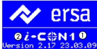
Nach dem Einschalten der Station erscheint für ca. 2 Sekunden der Einschaltdialog. Dieser zeigt die Stationsbezeichnung ① und Softwareversion ② der i-CON 1. Anschließend wechselt die Station automatisch in den Arbeitsmodus.
