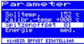
Durch die unterschiedlichen Massen und geometrischen Formen der Lötspitzen (Tip) ist deren Temperaturverhalten unterschiedlich.
