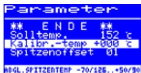
Diese Funktion dient zur Kalibrierung der Lötspitzentemperatur. Sie ermöglicht das Abgleichen von Anzeigewert und tatsächlicher Spitzentemperatur. Der einstellbare Kalibrierbereich beträgt  $-70$  bis  $+50$  °C /  $-126$  bis  $+90$  °F. Das genaue Vorgehen bei der Kalibrierung ist im Kapitel 6.3.6 [Kalibrieren] beschrieben.
