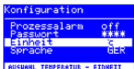
Hier können Sie die gewünschte Temperatureinheit Grad Celsius (°C) oder Fahrenheit (°F) auswählen. Werkseinstellung: „°C“
