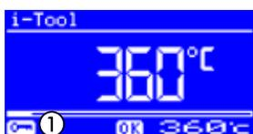
Die Daten der Station können über ein vierstelliges Passwort (0001-9999) geschützt werden. Dadurch wird verhindert, dass Einstellungen/Änderungen vorgenommen werden. Werksseitig ist kein Passwortschutz aktiviert. Dies wird durch [0000] im Passwordeingabefenster angezeigt. Das Schlüsselsymbol ① signalisiert, dass die Station geschützt ist. Werkseinstellung: [0000] = kein Schutz.
