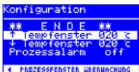
Für das angeschlossene Lötwerkzeug kann ein Temperaturfenster mit einem oberen und unteren Bereich definiert werden. Wenn sich die aktuelle Werkzeugtemperatur innerhalb dieses Fensters befindet, wird im Arbeitsmodus ein „OK“ angezeigt.
