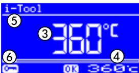
Im Arbeitsmodus kann die Lötspitzentemperatur direkt durch Drehen des i-OP verändert werden. Bestätigt wird dies durch Drücken des i-OP.
