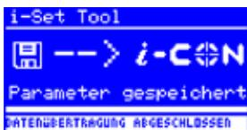
Displaykontrast, Kalibrierung und Offset werden nicht übertragen. Beim Übertragen der Daten in die Lötstation werden die Parameter aller Lötwerkzeuge überschrieben. Beachten Sie dies, wenn Sie an Ihren Lötstationen unterschiedliche Lötwerkzeuge betreiben.
