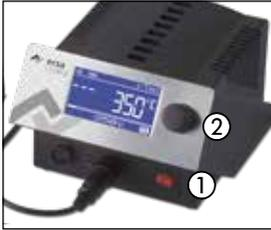
Das Ein/Ausschalten der Lötstation wird durch den auf der Frontseite befindlichen Schalter ① ausgeführt. Wenn die Lötstation eingeschaltet ist, leuchtet der Schalter rot.
