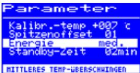
Diese Funktion gestattet es dem Anwender, das Regelverhalten der Station zu beeinflussen, wodurch das Auf- und Nachheizverhalten der Station auf das jeweilige Einsatzgebiet angepasst werden kann. Bei i-TOOL, X-TOOL VARIO, CHIP TOOL VARIO und TECH TOOL sind drei Einstellungen möglich: [high], [med.] und [low]. Alle anderen Tools arbeiten aufgrund der Regelcharakteristik mit konstanten Regelparametern.
