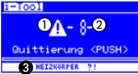
Die Lötstation führt selbständig Fehlerdiagnosen durch. Das Ergebnis einer Diagnose wird als Fehlercode ausgegeben: Dabei erscheint das dreieckige Piktogramm ① im Display der Lötstation. Der Fehlercode ② wird als Zahl zwischen 2 und 99 angezeigt.
