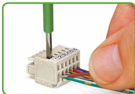
Leiter anschließen – Betätigung mit Schraubendreher (2,5 x 0,4 mm) rechtwinklig zur Leiteranschlussrichtung.
