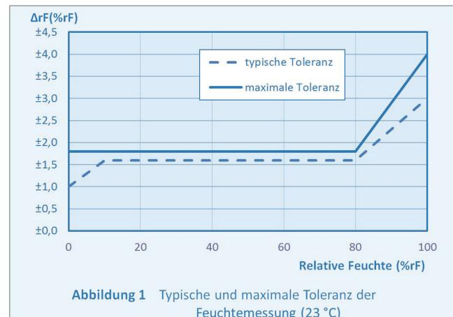
Abbildung 1 Typische und maximale Toleranz der Feuchtemessung (23 °C)
