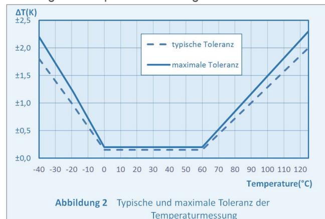
Abbildung 2 Typische und maximale Toleranz der Temperaturmessung
