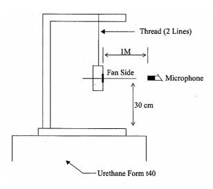
1 METER FROM MICROPHONE TO FAN INTAKE
