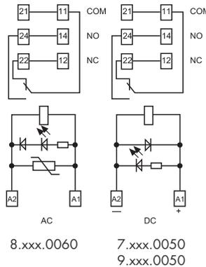
\* Bei einem Dauerstrom >10 A sind die Anschlüsse 11-21, 14-24, 12-22 zu brücken
