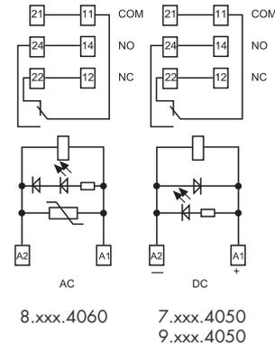
\* Bei einem Dauerstrom >10 A sind die Anschlüsse 11-21, 14-24, 12-22 zu brücken
