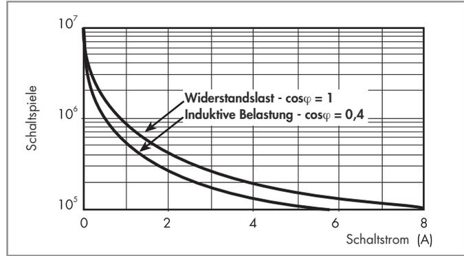
**H 49 - Gleichstromschaltvermögen bei DC1 - Belastung**
