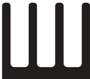
Profilkühlkörper und Flüssigkeitskühlkörper>Standardstrangkühlkörper
