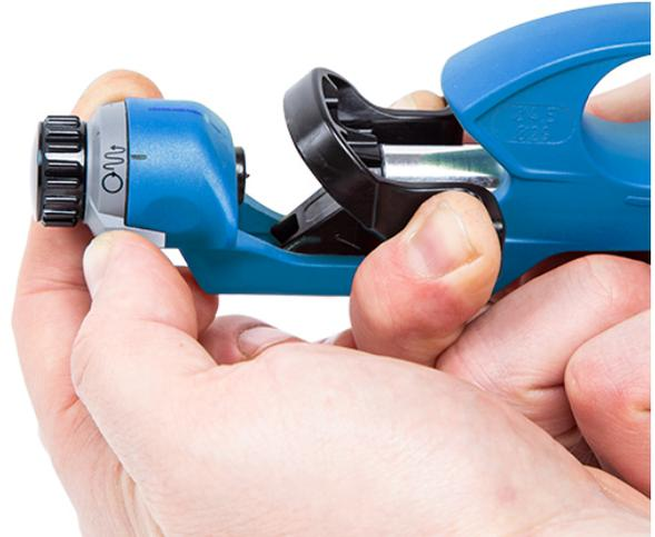
Das Kabelmesser No. 4-29 Spiral ist sehr robust, präzise und eignet sich sowohl für weiche als auch für harte Isolierungen von Kabeln mit einem Durchmesser von 4,5 - 29 mm. Die verschiedenen Schnittrichtungen für den Rund-, Spiral- und Längsschnitt lassen sich sicher über die jeweilige Rastposition mit dem Schalthebel einstellen. Durch den Spiralschnitt lassen sich auch komplexe Isolierungen einfacher entfernen.
