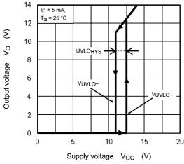
Fig. 13.2.11  $V_O(V_{UVLO})$  -  $V_{CC}$
