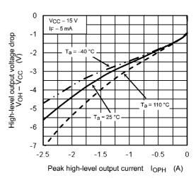
Fig. 13.2.10 (V<sub>OH</sub>-V<sub>CC</sub>) - I<sub>OPH</sub>
