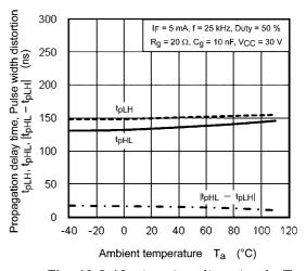
Fig. 13.2.12  $t_{pLH}$ , $t_{pHL}$ , $|t_{pHL}$ - $t_{pLH}$ | -  $T_a$
