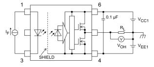
Fig. 13.1.3 V<sub>OH</sub> Test Circuit
