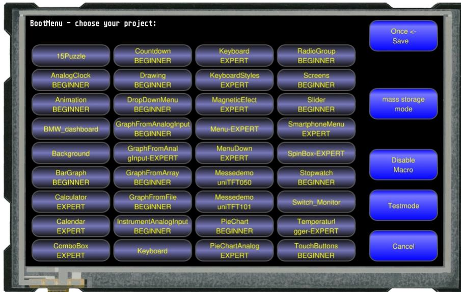
Um Missbrauch durch den Bediener zu vermeiden, kann das Bootmenü deaktiviert werden. Hierfür muss auf der SD-Card im Root-Verzeichnis die Datei "bootmenu.off" mit leeren Inhalt erzeugt werden. Das kann auch durch uniTFT Befehle erfolgen:
